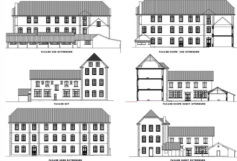
**Bâtiment regroupant les salles de classes** : isolation des murs par l'intérieur ( $R=5$ ), isolation des combles en ouate de cellulose ( $R=9$ ), ventilation double flux
